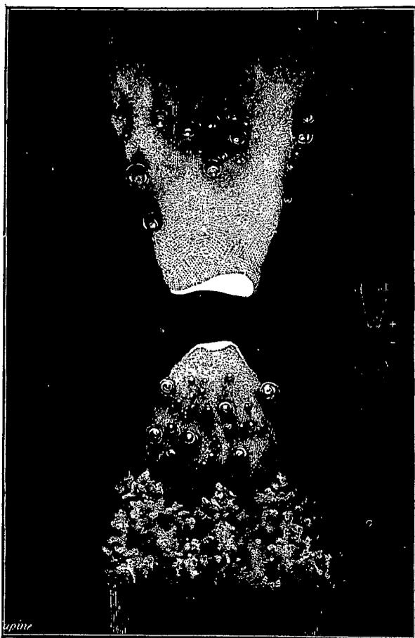
Fig. 6. — Image amplifiée des cônes de charbon pendant la production de l'arc voltaïque.
