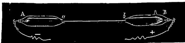
Fig. 71. — Tube de Geissler, pour l'étude des spectres d'émission des gaz.
