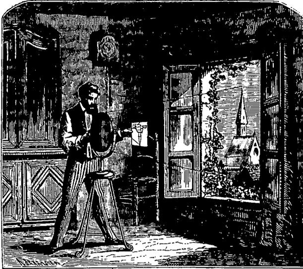
Fig. 28. — Image réelle produite par un miroir concave.
