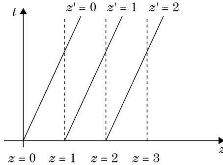
Figure 3 : Transformation de coordonnées linéaire. On peut dire, si l'on veut, que les coordonnées  $(z', t')$  sont représentées dans le système de coordonnées de base  $(z, t)$ .
