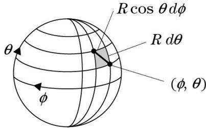
Figure 14 : Calcul de distance à la surface de la Terre. On a représenté les points  $(\phi, \theta)$  et  $(\phi + d\phi, \theta + d\theta)$ , et le segment qui les joint.
