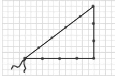
Figure I.19.6 : Corde à treize nœuds utilisée par les Égyptiens pour tracer des angles droits.
